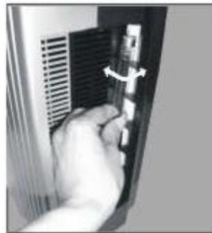
2. Greifen Sie die UV-Lampe und drehen Sie diese um 90°. Nun lässt sie sich heraus ziehen.
