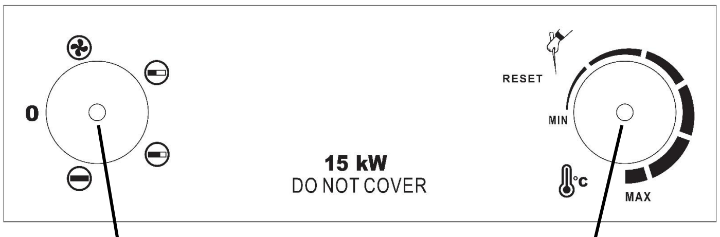
1. Manopola di regolazione della forza operativa
