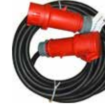
Kabeltyp: H07RN-F 5G10 Kabelquerschnitt: 10 mm 2 CEE-Stecker: 63A 5p 6h 400V CEE-Kupplung: 63A 5p 400V Länge: 10 m
