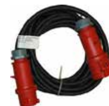
Kabeltyp: H07RN-F 5G4 Kabelquerschnitt: 4 mm 2 CEE-Stecker: 32A 5p 6h 400V CEE-Kupplung: 32A 5p 400V Länge: 10 m
